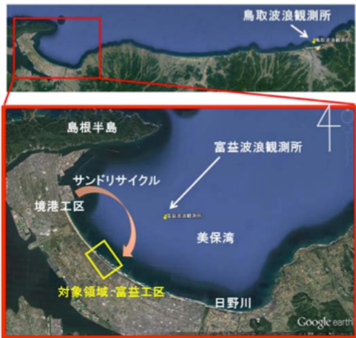
図5 皆生海岸および対象領域の概要(サンドリサイクル:境港工区から富益工区へ土砂輸送)
